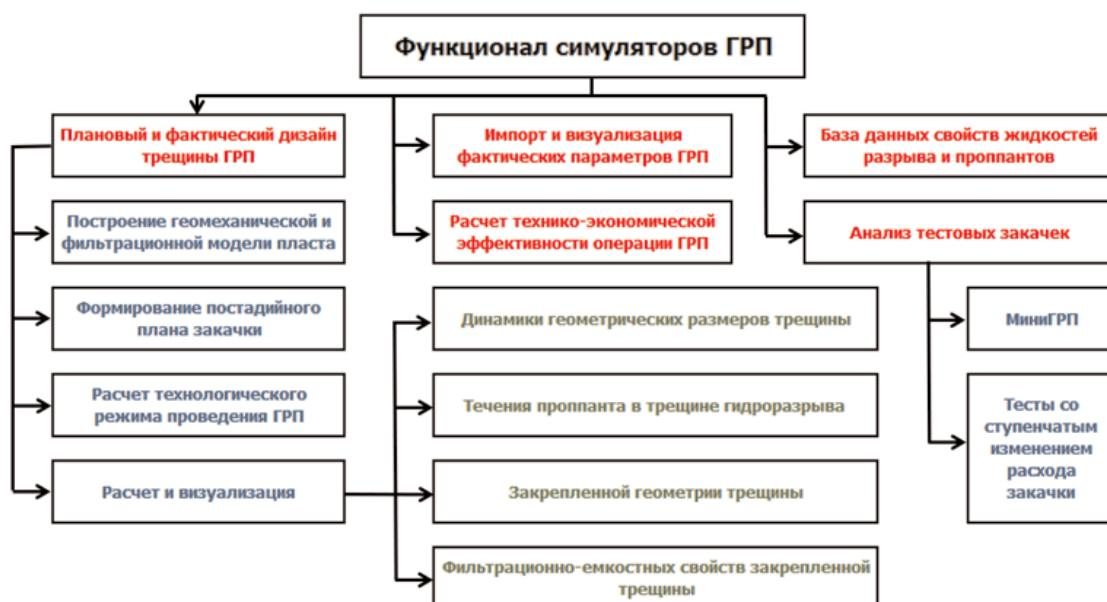
**Рис. 1. Основной функционал симуляторов ГРП**
